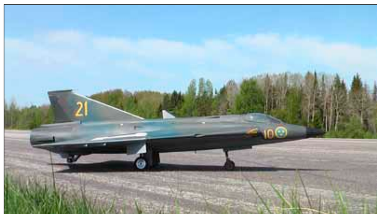
En modell av J 35 i samma storlek som Servalacksdraken. Även den här modellen är nu konverterad till jetmotordrift. Modellen är byggd av Einar Jonsson (f.d. fältflygare från F 6), som även gjort formarna till den glasfibergjutna kroppen.
