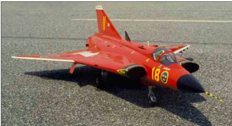
Servalacksdraken, en äldre modell i skala 1:8. Ursprungligen byggd av Ingemar Sjöberg, men flygs numera av Kenneth Näslund, som har konverterat modellen till jetmotordrift. Spännvidden är 1,2 m, vikten 9,1 kg och jetmotorn ger en dragkraft på cirka 98 N (10 kg).
