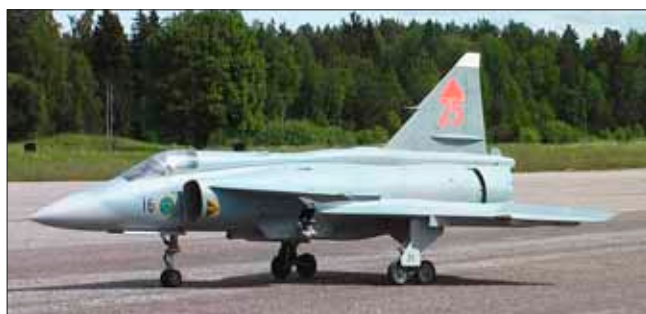
JA 37 Viggen. Även denna modell är konstruerad och byggd av Einar Jonsson. Skalan är 1:9, vilket ger 1,2 m spännvidd. En JetCat P60 jetmotor med 59 N (6 kg) dragkraft driver modellen, som har mer än 100 flygningar i loggboken.
