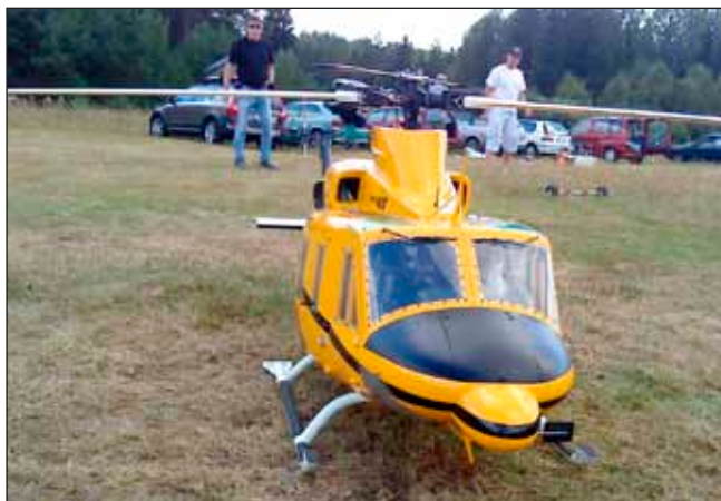
En modell av Bell 412, byggd av Lasse Palm. Precis som originalet så drivs modellen av en jetmotor. Skala 1:6,2 med rotordiameter 2,3 m och vikt ca 23 kg.
