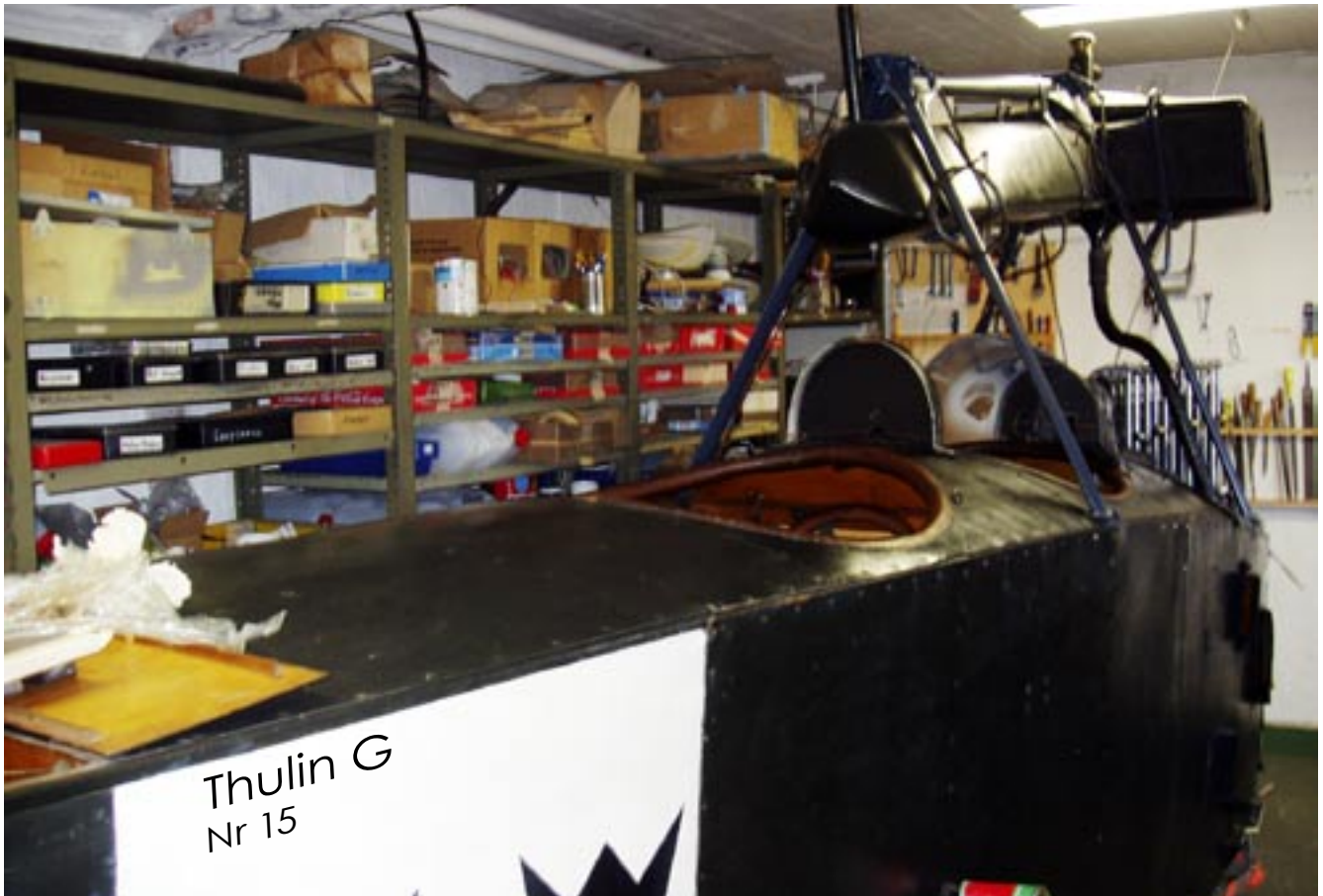
Flygkropp med motor i det närmaste klar. Vingarna fattas än så länge. De kan naturligtvis inte monteras i nuvarande byggnad, men färdigställs för montering vid flytt till Flygvapenmuseum.
