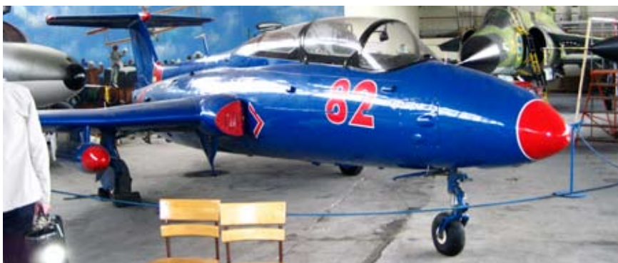
Aero Vodochody L 29 Delfin. Tvåsitsigt militär skol- och lätt attackjet. Flög första gången 1959. Serieproduktion från 1963. Över 3000 tillverkades. Ersattes av L 39 Albatross 1974
