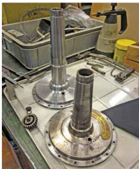
Nyttillverkad (bortre) och original motornäsa till Oberursel-motor för Flygbåt 10. Foto Gunnar Granberg.
