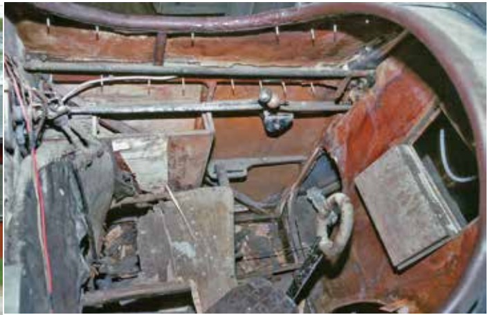
Främre förarplatsen på SK 5 före renovering. Resultatet efter en tids utomhusförvaring. Foto: Gunnar Granberg
