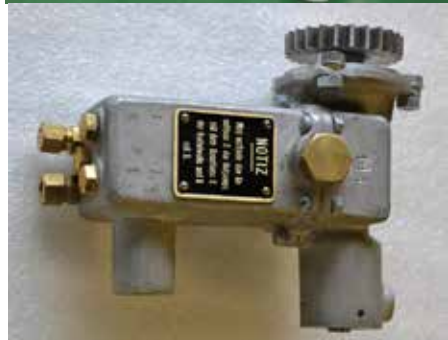
Tillverkning av oljepumpsattrapp till Oberursel-motorn för Flygfisken. Den övre bilden visar avgjutningen och den undre bilden det slutliga resultatet.
