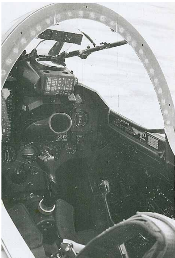
Obs: kameran syns ovan visirskiva samt gummistrut till radarskärm.
